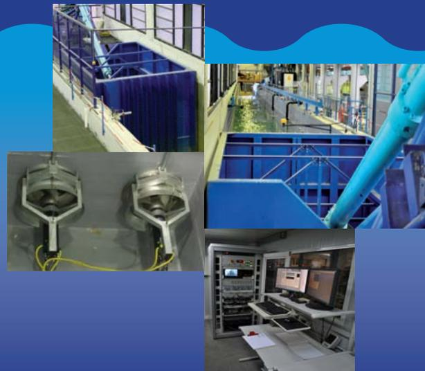
El programa de control permite la generación de oleaje regular e irregular (espectros parametrizados, definidos por el usuario, y series temporales). Adicionalmente, un sistema de absorción activa permite realizar experimentos para series de oleaje de cualquier duración sin los efectos de la reflexión inducida por el modelo físico. Esta es una característica esencial para los ensayos con estructuras con alta reflexión o para los análisis de formas de equilibrio de perfiles de playa.
