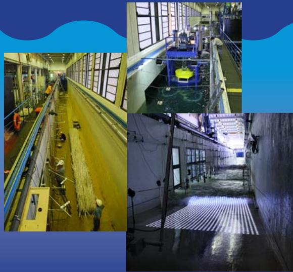
La utilización de escalas grandes permite reducir los efectos derivados de la experimentación con prototipos.
