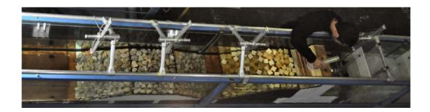
Para facilitar su operación, en ambos extremos hay dispuestos pozos de 0.20m de diámetro, que permiten tanto su llenado y vaciado así como la recirculación controlada de agua mediante el sistema de generación de corrientes. Igualmente cuenta con un depósito de 3m3 y un sistema de bombeo y filtrado propio a fin de mantener su autonomía de uso del resto de instalaciones.
